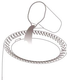
**⚠ Let op:** Giet het water langzaam en zo dichtbij mogelijk bij het apparaat naar binnen. Indien het hoog en snel worden gevuld kan het water aan de binnenkant van het apparaat gaan lekken en een defect veroorzaken.
