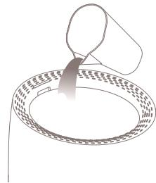
**⚠️ Uwaga:** Wodę należałoby wlewać do zbiornika powoli oraz z możliwie najmniejszej odległości. Jeśli woda będzie nalewana szybko bądź z dużej wysokości, może przedostać się do wnętrza nawilżacza powodując jego uszkodzenie.
