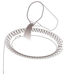
**Attention:** Versez de l'eau avec un arrosoir ou une bouteille. Si vous le remplissez directement du robinet le jet d'eau peut-être trop fort et de l'eau peut couler dans l'appareil et créer une panne.
