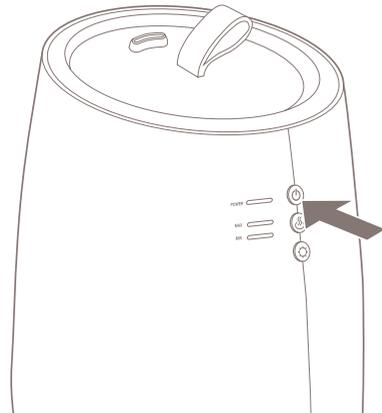
⚠ **Hinweis:** Wechselt die Strom-/Wasseranzeige bei Einschalten des Geräts von blau zu rot ist der Wasserstand im Gerät zu niedrig. Füllen Sie von oben Wasser in den dafür vorgesehenen Wassertank (siehe Punkt 2 „Befüllen des Wassertanks“).
